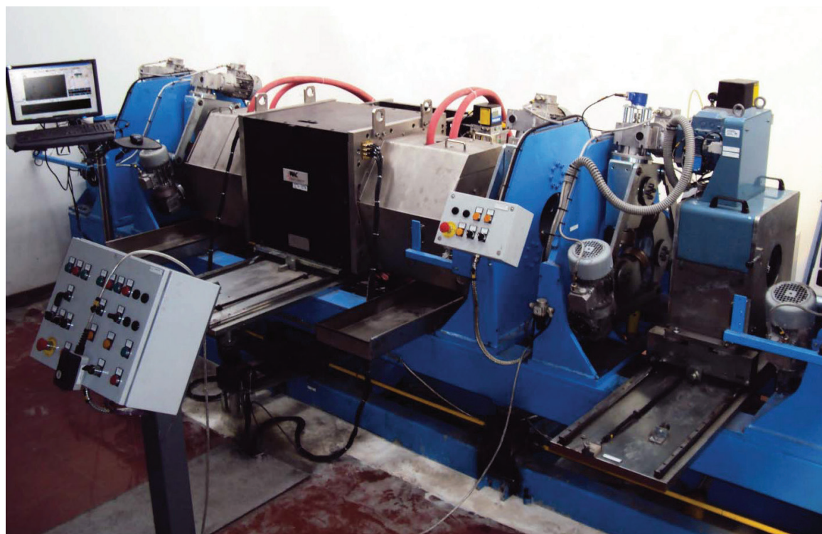
Système de contrôle de billettes rondes avec équipements courants de Foucault MultiMac® et Ultrasons Echomac®.
